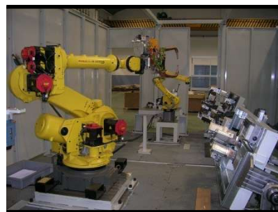
Cabina de soldadura automática
