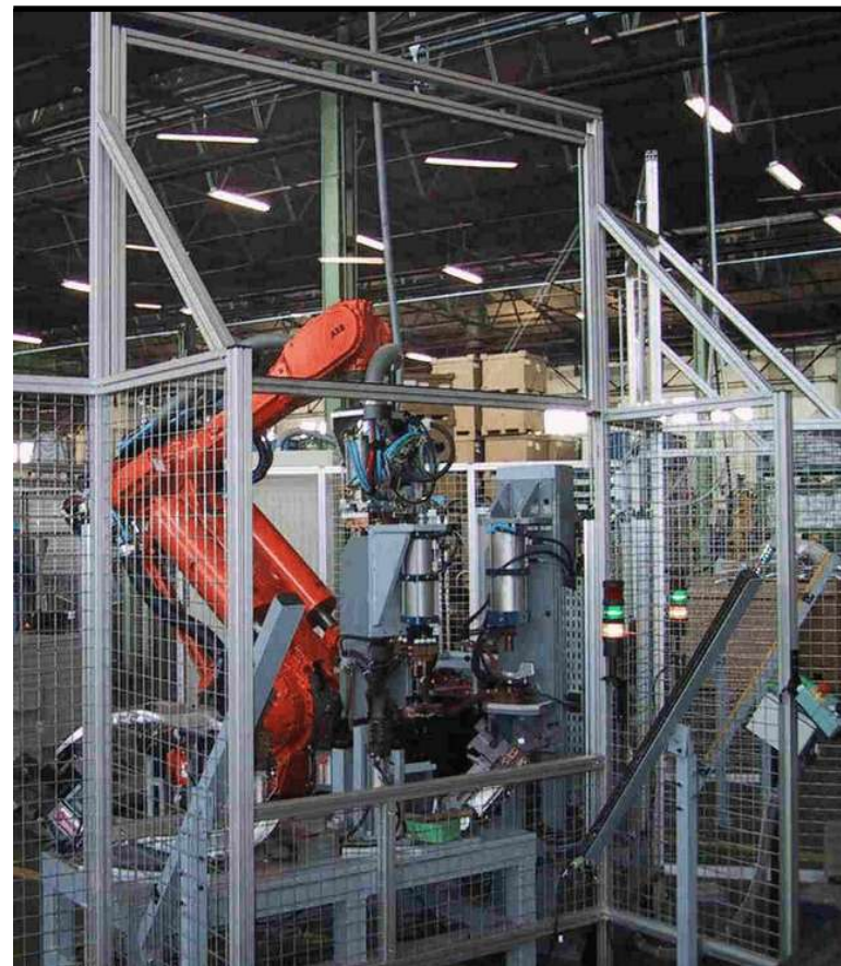
Robot de manipulación para cargar piezas unitarias en una cabina de soldadura
