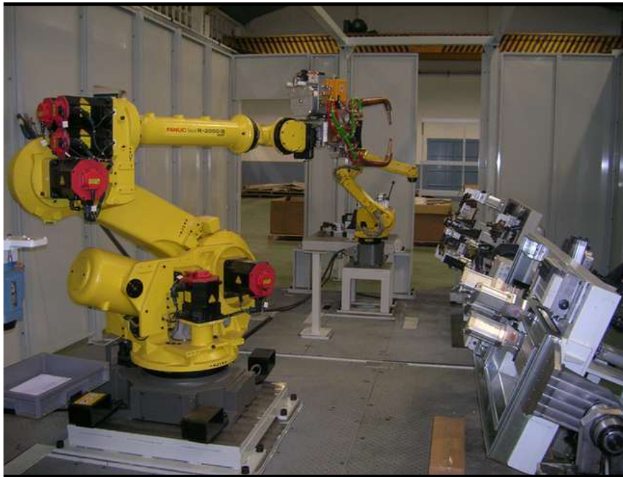
Cabina de soldadura automática
